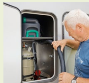
Die SOG-Entlüftung leitet schlechte Gerüche ab und spart auch etwas Kassettenkapazität.
