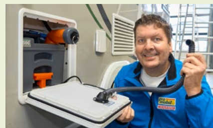
Die SOG-Entlüftung leitet schlechte Gerüche ab und spart auch etwas Kassettenkapazität.
