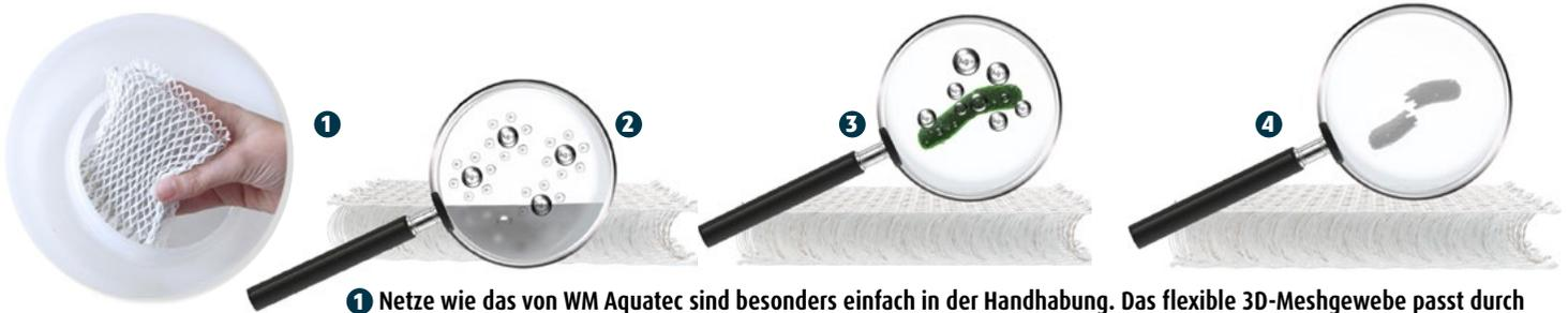
1 Netze wie das von WM Aquatec sind besonders einfach in der Handhabung. Das flexible 3D-Meshgewebe passt durch fast jede Tanköffnung. 2 Im Wasser lösen sich Silberionen und verteilen sich gleichmäßig. 3 Anschließend setzt die Wirkung ein: Die positiv geladenen Ionen „befallen“ die Zellmembran der Krankheitserreger und Keime. 4 Die Schädigung der DNA und des Zellstoffwechsels stoppt die Vermehrung.
