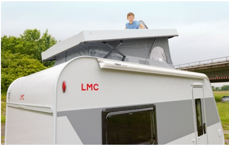
Die Außenwände der Sandwichplatten beim Caravan bestehen aus Glattblech-Aluminium oder dem etwas leichteren Hammerschlag.
